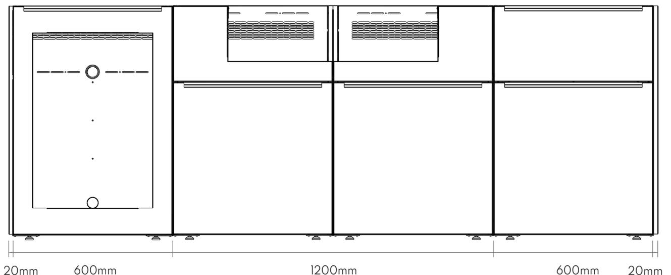
Basisbreite:  $20\text{mm} + 600\text{mm} + 1200\text{mm} + 600\text{mm} + 20\text{mm} = 2440\text{mm}$
